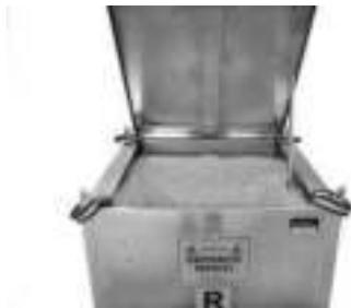
Corpo vasca a pianta rettangolare, pareti e fondo piani. Lamiera d'acciaio al carbonio prima qualità scelta. Portellone superiore incernierato, maniglia centrale di presa e asta antichiusura accidentale. Chiusura tramite leva di acciaio con scatto a pressione. Nr.4 piedi di appoggio a terra. Sedi per inserimento forche muletto o transpallet.
